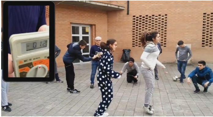
Fig. 6: Valor de la força electromotriu instantània enregistrada pel polímetre en fer girar la comba.
